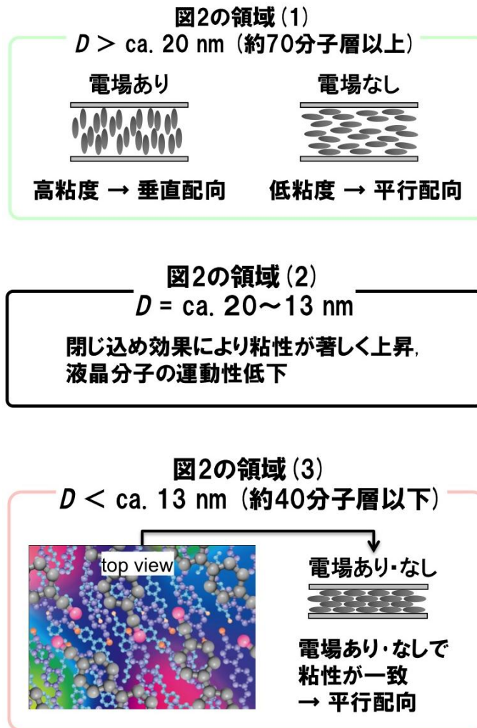
図4：雲母表面間の液晶 6CB の分子の配列の模式図
