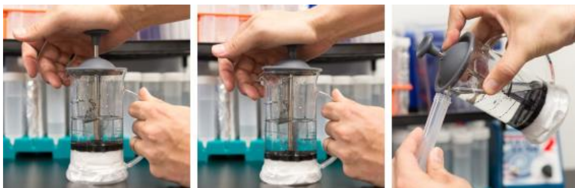
図 4 コーヒーポットを用いたジャイアントベシクル作製の様子
