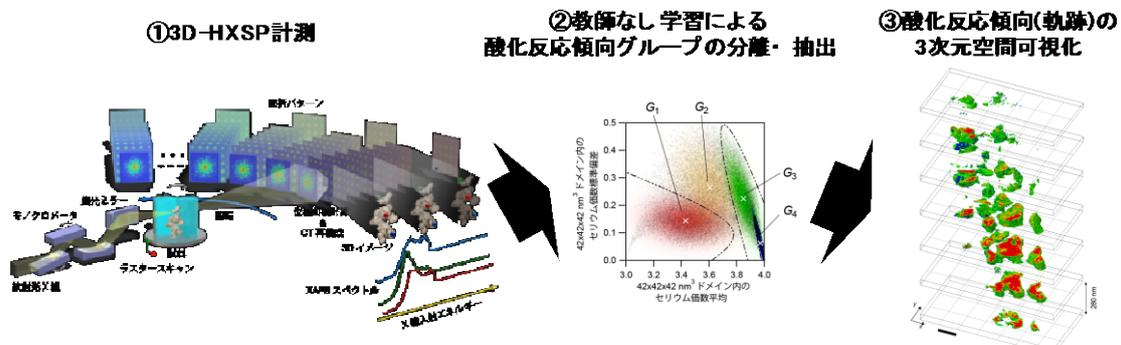
図 3D-HXSP 計測とデータマイニングによる酸素吸蔵・放出材料粒子内の酸化反応軌跡の可視化
