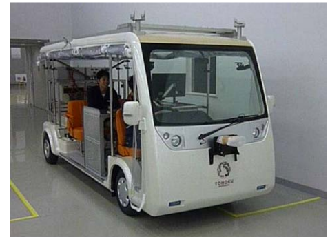
図5 後輪にアキシアルギャップ型SRモータを適用したインホイール方式の電気バス
