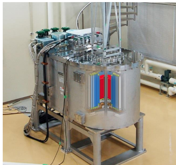
図 1.新しく開発した 25T 無冷媒超伝導マグネットの外観とコイルイメージ。高さ 1.2 m 幅 2.8 m × 奥行き 1.4 m。コイルは外からニオブチタン（水色）、ニオブ 3 スズ（青）、ビスマス系高温超伝導コイル（赤）の 3 種類によって構成されている。
