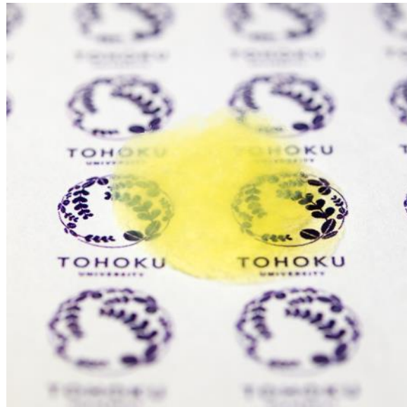
図 3 蛍光分子を分散させたクライオゲルの外観
