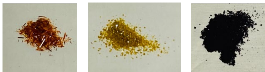
図2 (左)TTF 結晶、(中)TCNQ 結晶、(右)TTF と TCNQ を乳鉢で 20 分混合した粒子。表面での電荷移動により導電性が発現し黒色を示す。
