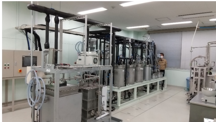
図2 上記のプロセスを実現するイオン交換樹脂法による製造装置 (ファイトケム・プロダクツ(株)提供)
