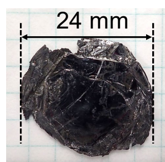
図 1 育成した硫化スズ単結晶。フラックスにハロゲンを加えない場合（左）と比べ、ハロゲンの添加により大幅な結晶サイズの増加に成功（中：塩素添加、右：臭素添加）。
