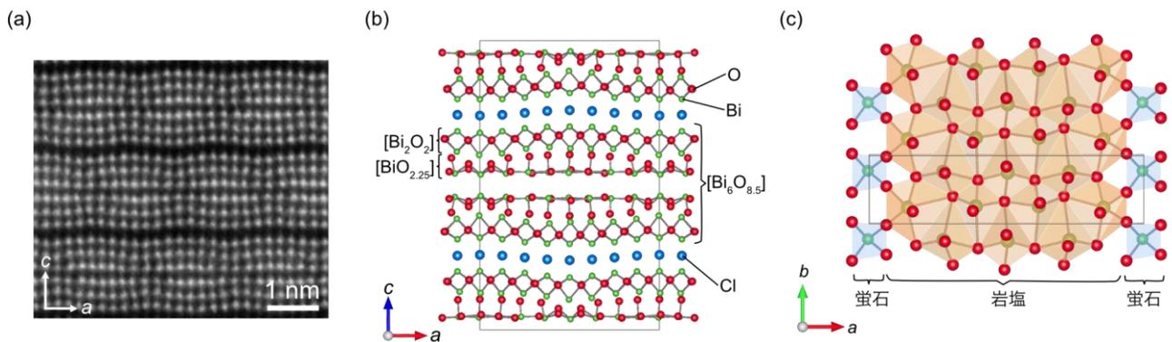
図 2: (a)  $\text{Bi}_{12}\text{O}_{17}\text{Cl}_2$  の電子顕微鏡像。ここでは Bi のみが白い点で見えています。Bi の列が 6 列存在し、 $a$  軸方向にまっすぐではなく、波打っていることが見てとれます。(b) 本研究で明らかとなった  $\text{Bi}_{12}\text{O}_{17}\text{Cl}_2$  の結晶構造。電子顕微鏡や X 線回折などの手法を組み合わせることで初めて構造が明らかになりました。(c)  $c$  軸方向から見た  $\text{BiO}_{2.25}$  ブロック。  $\text{BiO}_{2.25}$  ブロックには、岩塩型構造のような配位多面体 (オレンジ) と蛍石型構造 (水色) のような配位多面体が共存しています。
