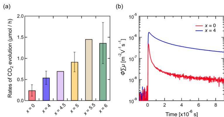
**図 4: (a) 酢酸分解に対する光触媒活性。** Bi<sub>12</sub>O<sub>17-0.5x</sub>F<sub>x</sub>Cl<sub>2</sub> のフッ素量  $x$  が増えるに従って、光触媒活性が大幅に向上しています。**(b) フッ素化前後の光伝導度。** フッ素化後に光伝導度の向上が見られ、光吸収によって生じた電子がスムーズに表面に移動することで、光触媒活性が向上したと考えられます。
