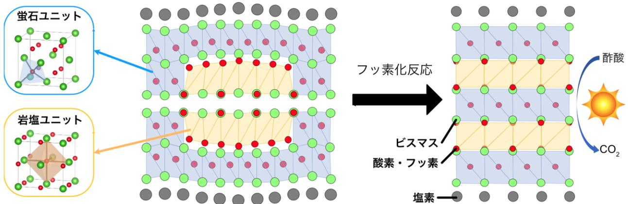
岩塩型構造に似た構造を有する岩塩ユニット（オレンジ色の部分）と蛍石型構造に似た構造を有する蛍石ユニット（水色の部分）が複合した初の層状酸塩化物Bi<sub>12</sub>O<sub>17</sub>Cl<sub>2</sub>とフッ素挿入反応による岩塩/蛍石ユニットの再配列。岩塩/蛍石ユニットの再配列により、Bi<sub>12</sub>O<sub>17</sub>Cl<sub>2</sub>の波打っていた層が平坦になり、光触媒活性が向上した。
