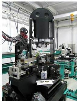
水素化物の形成過程の観測に使用された放射光X線回折装置
