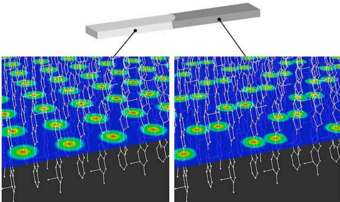
図 2 : 有機分子でできた結晶（固相）中で、2つの異なる電子の状態が空間的に住み分けて存在している様子の概念図。SPring-8 の BL43IR の赤外顕微分光技術を利用して試料を観察した結果、同じ固相という状態であるにもかかわらず、試料の左側と右側で、電子の分布の状態が異なっていることが分かった。[左側：ダイマーモット状態と呼ばれる、電子が2つの分子（ダイマー）上に存在している状態、右側：電荷秩序状態と呼ばれる、2つの電子がペアを組むようにしてチェッカーボード型に配列した状態]
