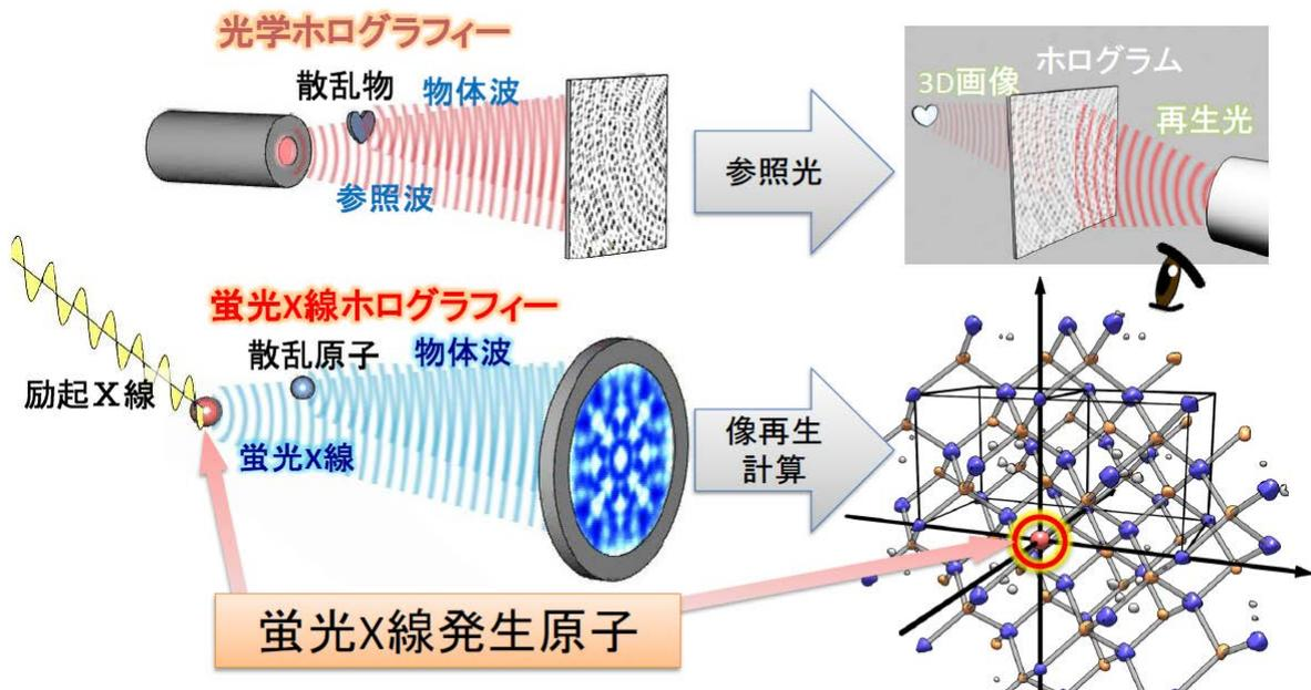
蛍光X線ホログラフィーも基本的には、光学ホログラフィーと同じ原理を用いています。蛍光X線とは、あるX線を原子に吸収させた後に放出されるX線のことです。それぞれの元素に固有の波長をもちます。図に示してあるように、ある原子から放出された蛍光X線は近くの原子によって散乱され、それが物体波となります。物体波は蛍光X線発生原子からの参照波と干渉しホログラムを形成します。そのホログラムパターンは、X線カメラで観測できます。像の再生については、再生光を利用できないので計算機を用いて行います。本手法は特に、単結晶中の微量不純物元素周りの3次元局所構造評価に有効であることが実証されています。
