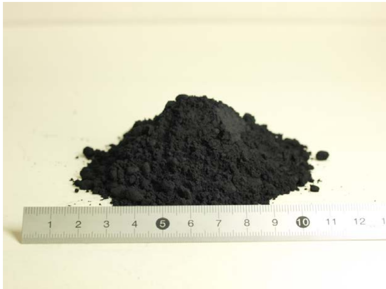
図 2 開発した高結晶性オープンセル型ポーラス炭素粉末の外観写真
