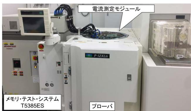
図 1 : STT-MRAM の評価に用いたメモリ・テスト・システム (T5385ES) と試験環境
