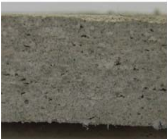
図1 前処理を行い石綿スレート中の白石綿を選択的に染色
