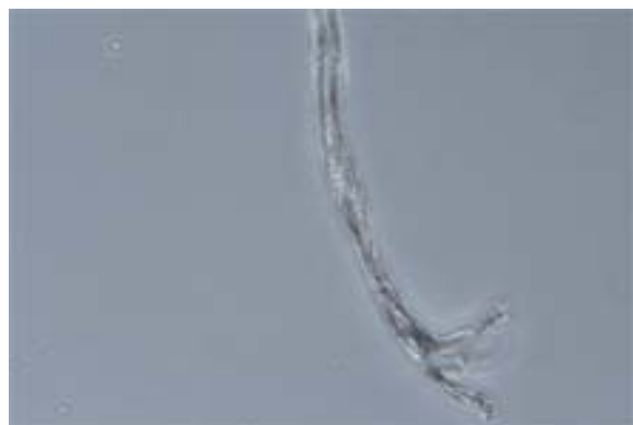
図1 前処理を行い石綿スレート中の白石綿を選択的に染色
