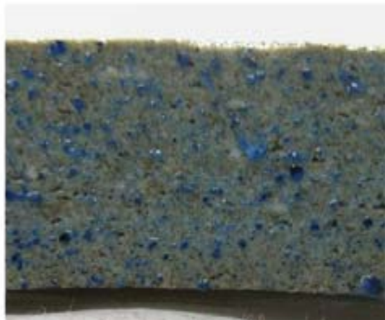
図1 前処理を行い石綿スレート中の白石綿を選択的に染色
