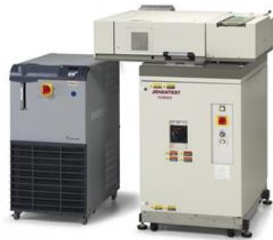
図1 本研究でSTT-MRAMの評価に用いたアドバンテスト社製メモリテスター(T5385ES)。
