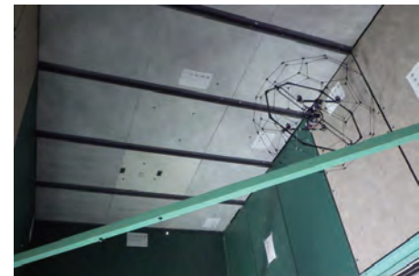
人工気象室での天候耐性試験
