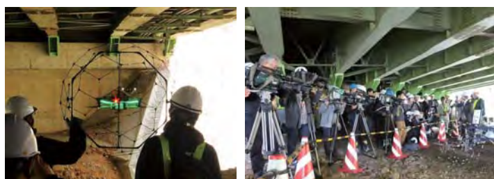
平成 29 年 5 月 16 日 龍沢橋 カメラ搭載ドローンを活用した橋梁点検の実証実験を仙台市と実施しました。
