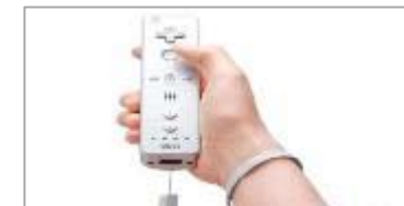
ゲームコントローラ (加速度・角速度センサ)
