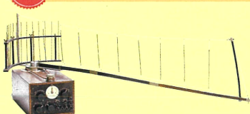
八木・宇田アンテナ 世界中の屋根に普及した テレビアンテナの基礎技術 所蔵：東北大学
