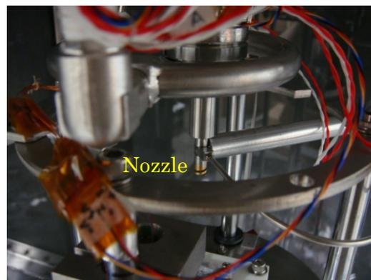
微細固体窒素粒子噴霧を用いた半導体洗浄用ノズル
