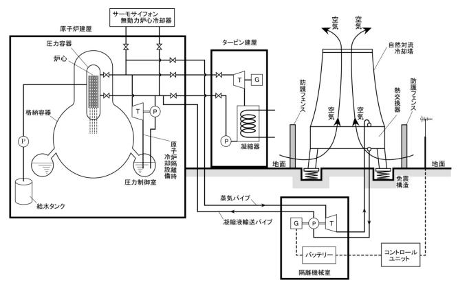
無動力原子炉冷却装置
