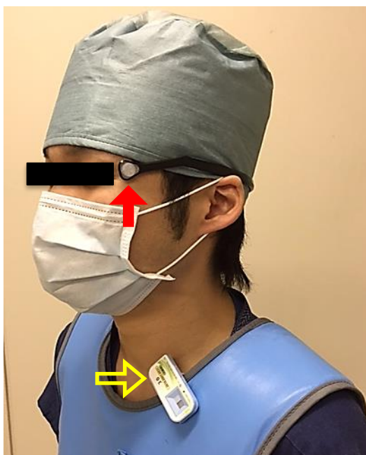
図 1. 左目付近 (水晶体近傍) に装着 (↑) した新しい水晶体線量計 (DOSIRIS™)
