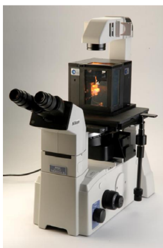
図 3 ナノ走査型電気化学顕微鏡(NanoSECM)
