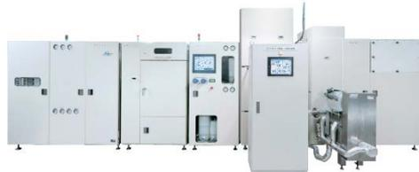
開発した超臨界水熱合成装置(10t/年)
