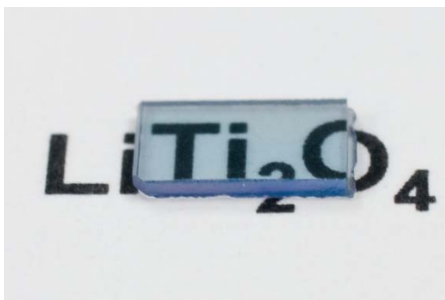
図1 \text{LiTi}_2\text{O}_4 透明超伝導体の写真。基板の下の \text{LiTi}_2\text{O}_4 という文字がはっきりと見える。膜の厚みは約170nm。可視光で約60%の透過率を示す。
