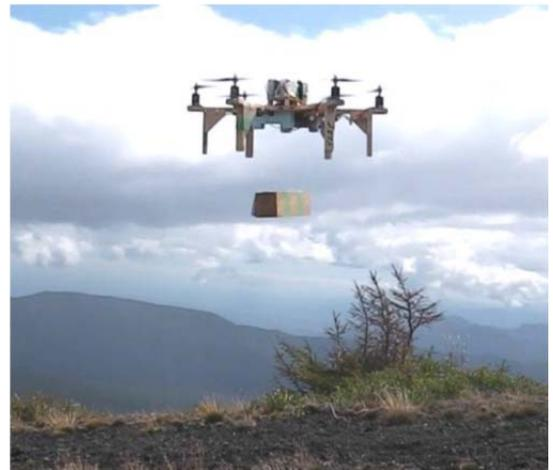
図 3 マルチコプタのペイロード投下試験
