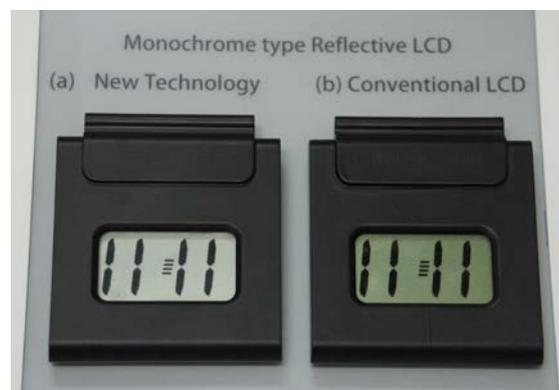
開発した反射型液晶ディスプレイ
