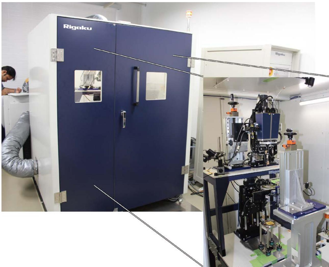
図2 開発した装置の写真。最下部のX線管から上向きにX線が照射される。
