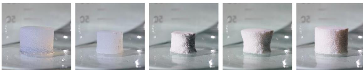
図 3 : BNF-PMSQ 多孔体を蒸発している様子（左から右）
