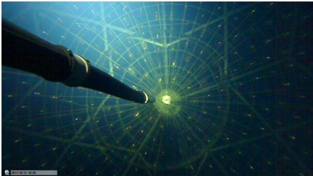
カムランド中心に導入されたキセノン含有液体シンチレータを内包するバルーン (背景のフレームが屈折して見えている部分)
