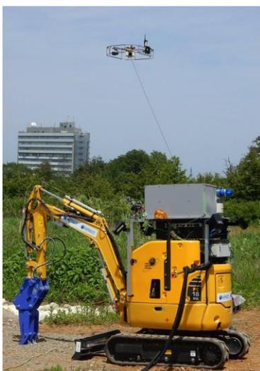
図 7 有線給電ドローン
