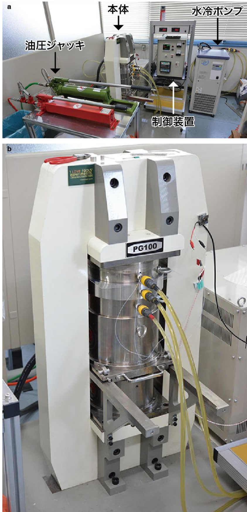
図 4：複数相飽和実験に用いたピストンシリンダー型高温高压発生装置（京都大学所有）。
