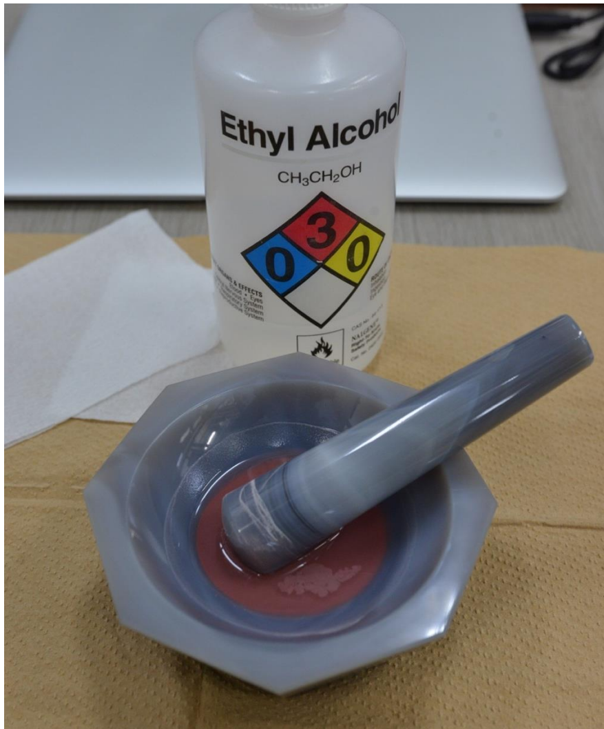
図3：実験出発物質と作成時の様子。各元素の酸化物、水酸化物、および炭酸塩の試薬（粉末）をエタノールの中で混合して初生マグマ組成を再現した。
