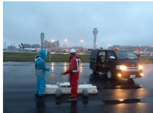
従来の打音検査に置き換わる新しい電波技術の導入
