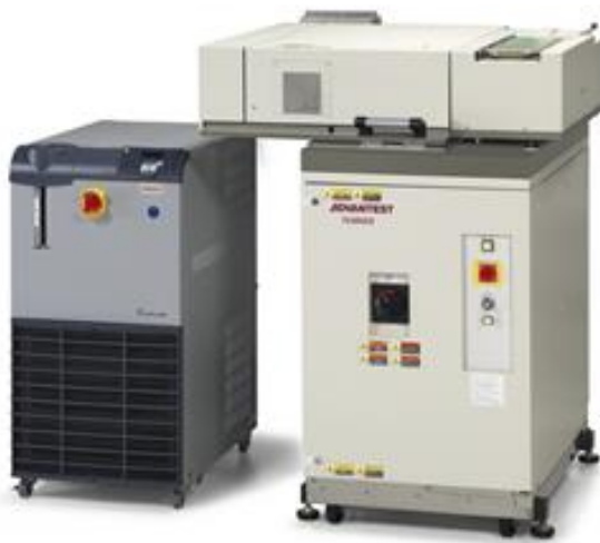
図1 本研究でSTT-MRAMの評価に用いたアドバンテスト社製メモリテスター(T5385ES)。
