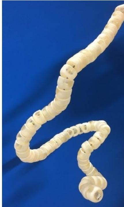
図5：柔剛切り替え可能な線状メカニズム（1次元ジャミング機構）の外観
