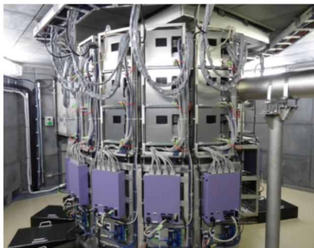
飛行時間ラウエ法と広い検出器立体角による高効率なデータ収集を可能にした J-PARC MLF BL18 の単結晶中性子回折装置「千手」。(a) 外観図、(b) 実際の装置。
