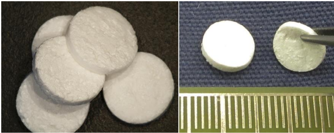
図 1. OCPcol(商品名 コラーゲン使用人工骨「ボナーク ® 」(Bonarc ® ))の外観および特徴
