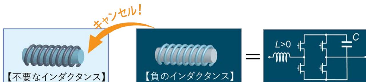
図3: 負のインダクタンスの使用例(左・中央)と、従来技術による負のインダクタンスの実施例(右)
