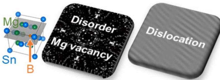
マグネシウム錫化合物のマグネシウムをホウ素で部分置換することで、ホウ素周辺のマグネシウムが欠損して結晶の周期性が乱れるとともに転位が生じ、熱伝導率を低減することに成功した。左、中央、右の画像は、それぞれマグネシウム錫化合物の結晶構造、中性子ホログラフィーで明らかになったホウ素周辺の原子像、および透過型電子顕微鏡像を示している。
