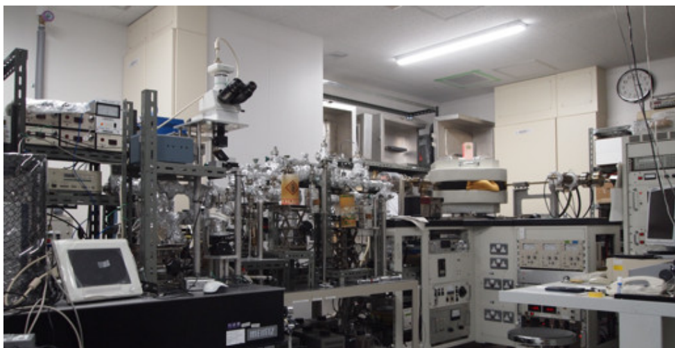
【揮発性成分分析チーム】 コンテナから採取されたガスや固体粒子中のガスに含まれる希ガスを分析する質量分析装置（九州大学）。
