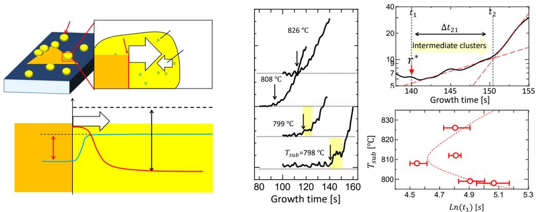
図 3: (a,b)TMD 結晶成長界面における(a)液体前駆体との関係と(b)熱力学パラメータ ( $F$ : 結晶成長駆動力、 $\mu_{L(S)}$ : 液相(固相)の化学ポテンシャル)、 $\Delta\mu$ : 液相と固相の化学ポテンシャル差、 $\Delta T$ : 固体結晶の融点と液相前駆体との温度差)との相関図。(c)異なる基板温度条件で成長した単層  $WS_2$  面積の時間変化。(d)結晶成長初期における単層  $WS_2$  面積の時間変化, 及び(e)基板温度( $T_{sub}$ )と結晶核発生時間( $t_1$ )との関係。
