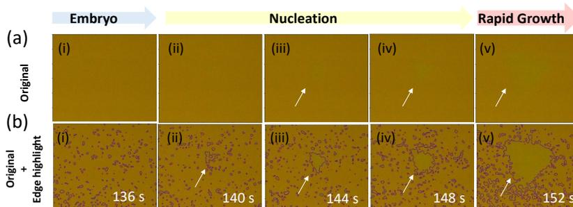
本研究で開発したその場観測 CVD と自動画像解析による TMD 結晶成長評価概略図。その場観測 CVD で観測した(a)オリジナル画像と(b)自動画像解析により結晶輪郭をハイライトした画像の成長時間発展の様子。
