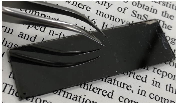
図2 世界で初めて作製に成功した有害元素を含まないn型伝導性の硫化スズ薄膜。
