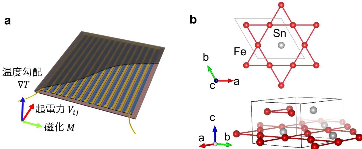
図 1 : 磁気熱電効果を活用した熱電変換モジュールと  $\text{Fe}_3\text{Sn}$  の結晶構造の概念図
