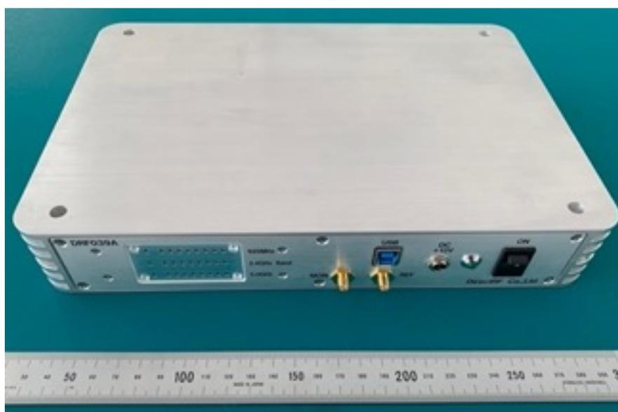
図4 試作した広帯域リアルタイムスペクトラムモニター(本体)
