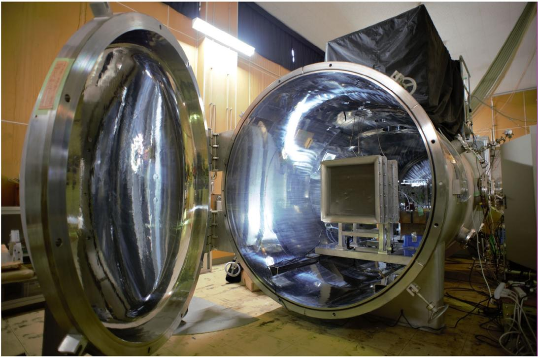
图 2. 火星大气风洞外观
