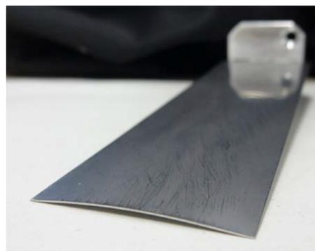
図 1. ヘリコプターブレードの風洞模型
