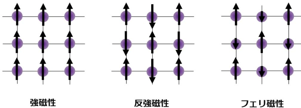
図3 強磁性、反強磁性、フェリ磁性における磁気モーメントの配列
