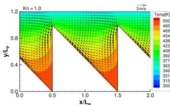
図2: 両面間の温度分布と熱的誘起流れ
