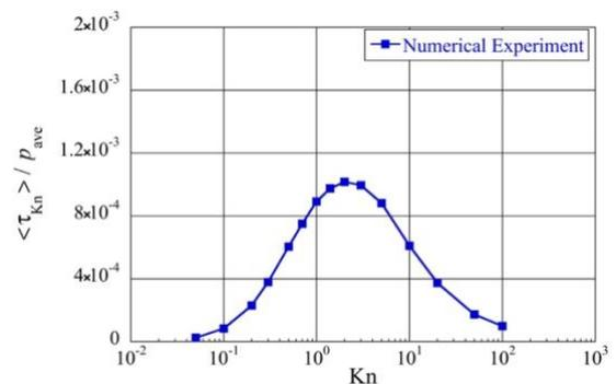
図3: 接線方向クヌッセン力 $\langle \tau_{Kn} \rangle$
