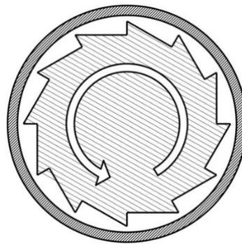
図5:クヌッセン力を用いたモーター
