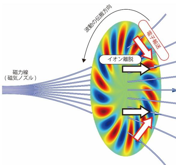
図 1: イオンの離脱と電子内向き輸送現象のイメージ図。
