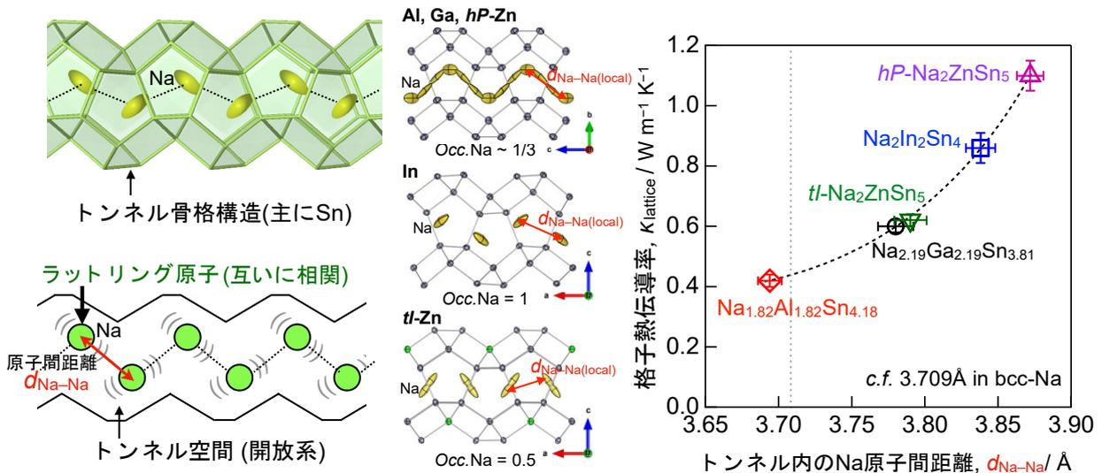
概略図. 結晶構造内にトンネル空間を有した金属間化合物( $\text{Na-X-Sn}$  系化合物,  $X$  は Al, Ga, In, Zn)では、トンネル内の Na 原子はトンネルの伸長方向に沿って大きな振幅で振動 (ラットリング) しており、それら Na 原子の局所的な原子間距離( $d_{\text{Na-Na}}$ )が近い化合物ほど格子熱伝導率が低下することが明らかにされました。トンネル内の原子鎖様のラットリング原子が互いに強く相関することによって引き起こされる、熱伝導率の新しい低減機構です。
