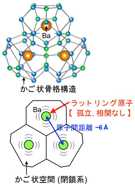
図5. トンネル構造化合物とカゴ状構造化合物におけるラットリング原子の配置。本研究で対象としたトンネル構造化合物（左）では、トンネル内に配置したNa原子はトンネルの伸長方向に沿ったラットリング状態であり、それらの原子間距離が近い化合物ほど低い熱伝導率を有することが明らかにされました。従来の代表的な低熱伝導性の金属間化合物であるカゴ状構造化合物（右）でも、ラットリング原子は熱伝導率の低減に寄与しますが、そのラットリングは等方的で、カゴ状の閉じた空間内に孤立して存在しています。
