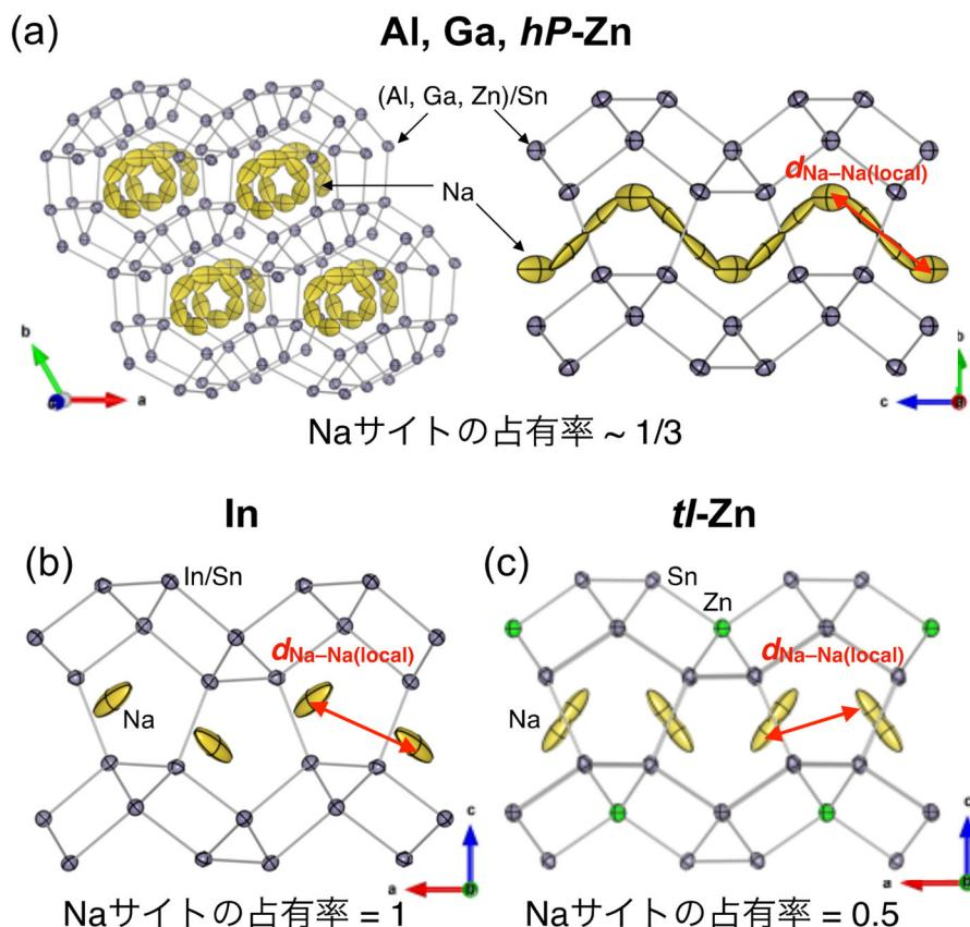
図1. トンネル構造を有する金属間化合物の結晶構造 ( $\text{Na}-X-\text{Sn}$ 系化合物,  $X=\text{Al}, \text{Ga}, \text{In}, \text{Zn}$ , (a)  $\text{Na}_{2+\delta}X_{2+\delta}\text{Sn}_{4-\delta}$  ( $X=\text{Al}, \text{Ga}$ ) と  $h\text{P}$ - $\text{Na}_2\text{ZnSn}_5$ , (b)  $\text{Na}_2\text{In}_2\text{Sn}_4$ , (c)  $t\text{I}$ - $\text{Na}_2\text{ZnSn}_5$ )。化合物によってNaサイトの占有率が異なります。いずれの化合物でもNa原子はトンネルの伸長方向に沿って大きな振幅で振動している。
