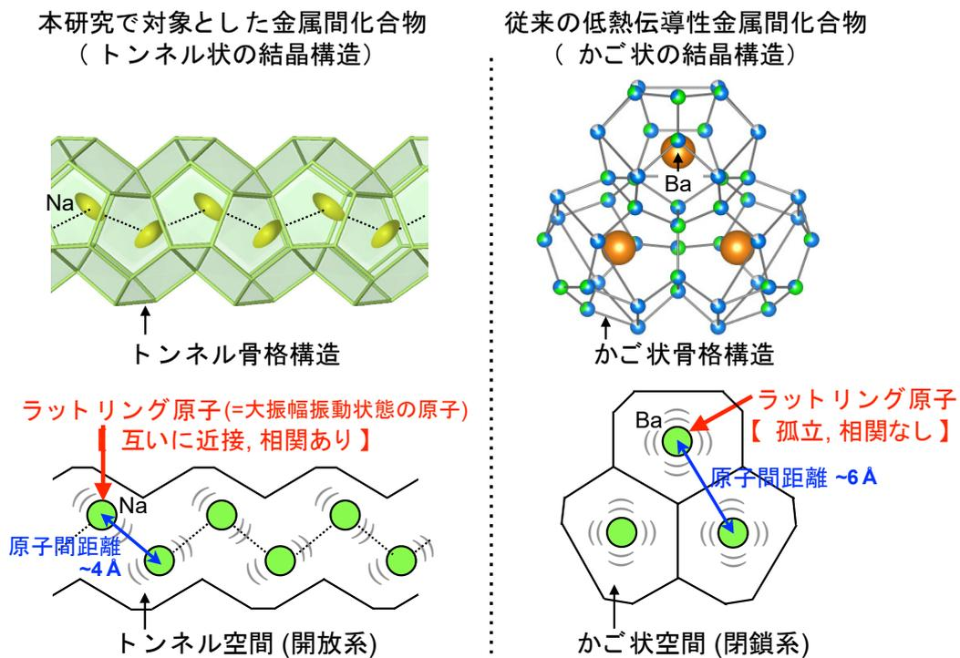
図5. トンネル構造化合物とカゴ状構造化合物におけるラットリング原子の配置。本研究で対象としたトンネル構造化合物(左)では、トンネル内に配置したNa原子はトンネルの伸長方向に沿ったラットリング状態にあり、それらの原子間距離が近い化合物ほど低い熱伝導率を有することが明らかにされました。従来の代表的な低熱伝導性の金属間化合物であるカゴ状構造化合物(右)でも、ラットリング原子は熱伝導率の低減に寄与しますが、そのラットリングは等方的で、カゴ状の閉じた空間内に孤立して存在しています。
