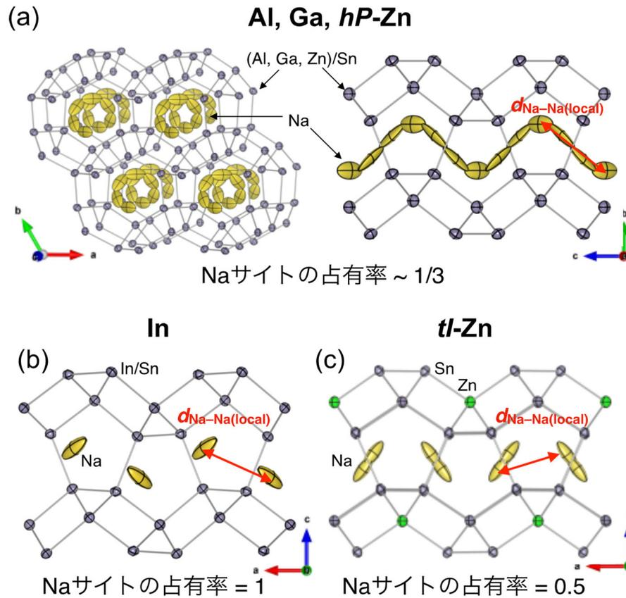
図1. トンネル構造を有する金属間化合物の結晶構造 (Na-X-Sn系化合物,  $X = \text{Al, Ga, In, Zn}$ , (a)  $\text{Na}_{2+\delta}\text{X}_{2+\delta}\text{Sn}_{4-\delta}$  ( $X = \text{Al, Ga}$ )と $hP\text{-Na}_2\text{ZnSn}_5$ , (b)  $\text{Na}_2\text{In}_2\text{Sn}_4$ , (c)  $tI\text{-Na}_2\text{ZnSn}_5$ )。化合物によってNaサイトの占有率が異なります。いずれの化合物でもNa原子はトンネルの伸長方向に沿って大きな振幅で振動している。
