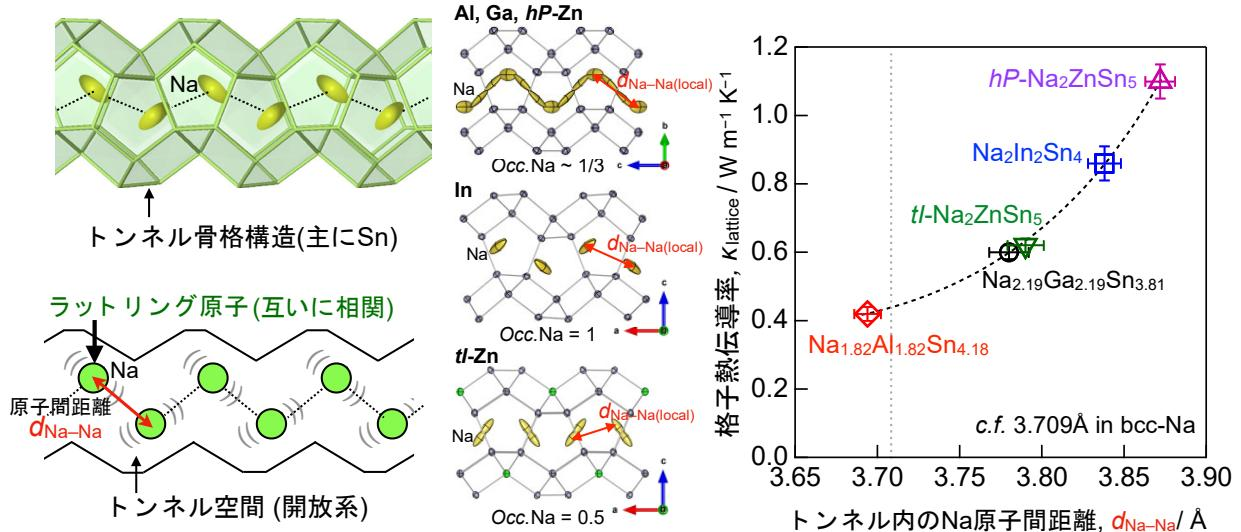
概略図。結晶構造内にトンネル空間を有した金属間化合物( $\text{Na}-X-\text{Sn}$ 系化合物,  $X$ はAl, Ga, In, Zn)では、トンネル内のNa原子はトンネルの伸長方向に沿って大きな振幅で振動(ラットリング)しており、それらNa原子の局所的な原子間距離( $d_{\text{Na}-\text{Na}}$ )が近い化合物ほど格子熱伝導率が低下することが明らかにされました。トンネル内の原子鎖様のラットリング原子が互いに強く相関することによって引き起こされる、熱伝導率の新しい低減機構です。
